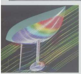
Écoulement d'un fluide réel autour d'une carène d'ACC (America Cup Class) réalisée avec le code ICARE du LMF (Laboratoire de Mécanique des Fluides).
