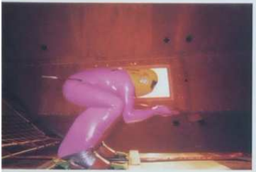
Étude aérobiomécanique d'une configuration de skieur de kilomètre lancé en soufflerie.
