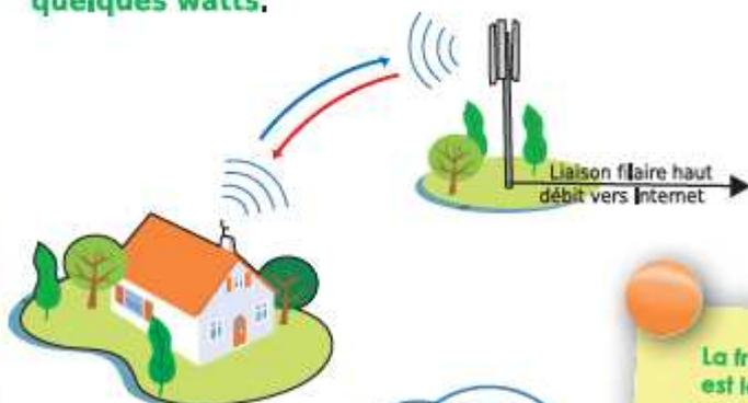
La fréquence d'émission d'un émetteur Wi-Fi est la même que celle d'un four à micro-ondes (2400 MHz). La puissance rayonnée maximum est de 0,1 watt pour le Wi-Fi et de 1000 watt pour le four, soit 10 000 fois moins. En conséquence, le Wi-Fi n'entraîne aucun effet d'échauffement.
