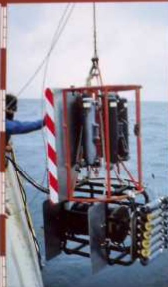
Les tubes Nippon (en jaune) sont utilisés pour la mesure de la température, de la salinité et de la conductivité. Ils sont reliés à un système de mesure qui permet de mesurer les variations de ces paramètres.
